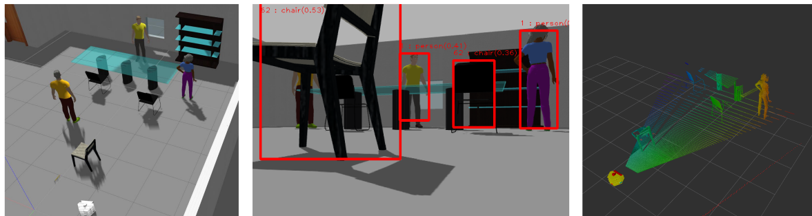
FIGURE 3.27 : L'image de gauche montre l'environnement virtuel Gazebo dans lequel le robot évolue. L'image du milieu montre la reconnaissance des obstacles à travers le capteur RGB. La dernière image à droite montre le rendu du capteur de profondeur dans Rviz .
