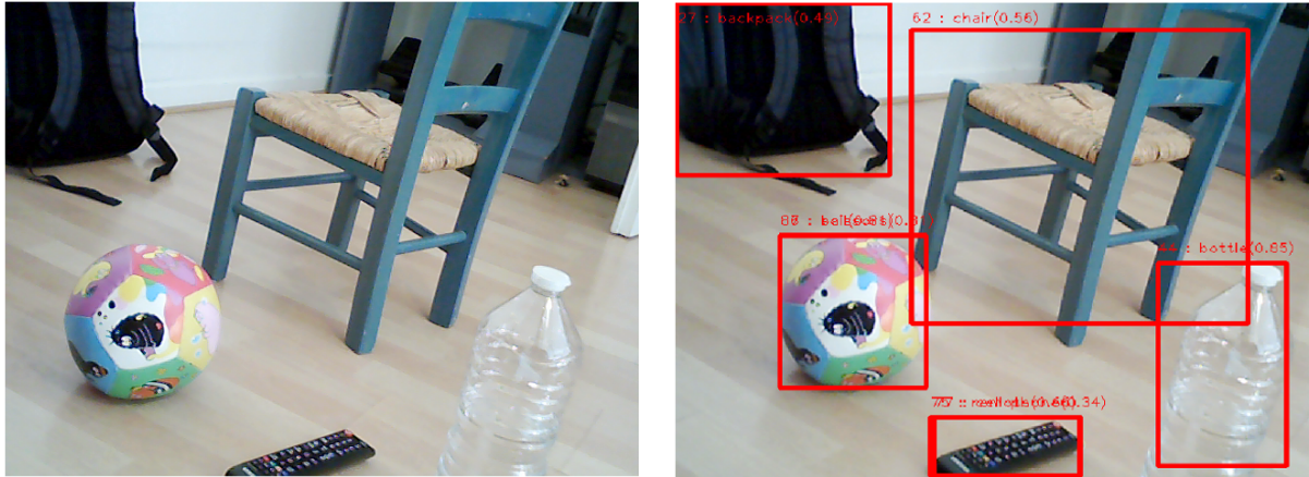
FIGURE 3.26 : Détection des objets : L'image RGB de gauche montre l'image telle qu'elle est reçue par le capteur RealSens RS300. L'image de droite montre la reconnaissance des objets encadrés en rouge avec le label correspondant et l'indice de confiance.
