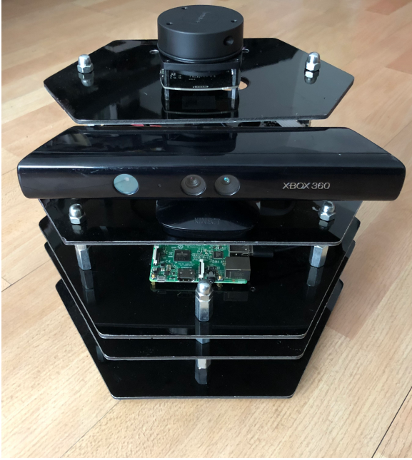
FIGURE 3.4 : Robot utilisé lors des premières simulations, nous l'avons entièrement conçu. Cette plateforme a été bondonnée au profit d'une Turtlebot3 .
