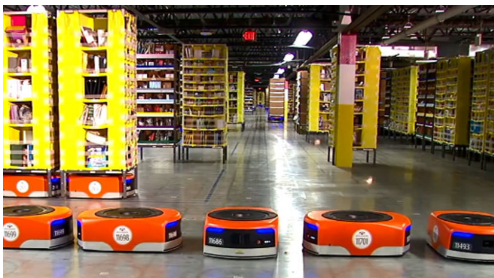
FIGURE 1.4 : Premier centre de distribution robotisé de la société Amazon à Brétigny-sur-Orge en France (2014), les robots ont permis de réduire le temps d'acheminement des colis à 13 minutes contre une heure et demie en moyenne auparavant.
