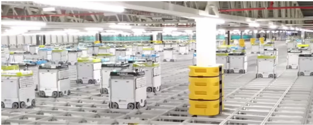
FIGURE 1.3 : Entrepôt de l'épicier Ocado , les robots mobiles circulent grâce à un algorithme centralisé de contrôle de trafic pour éviter les collisions. Les robots ont pour mission de préparer les commandes en-ligne.
