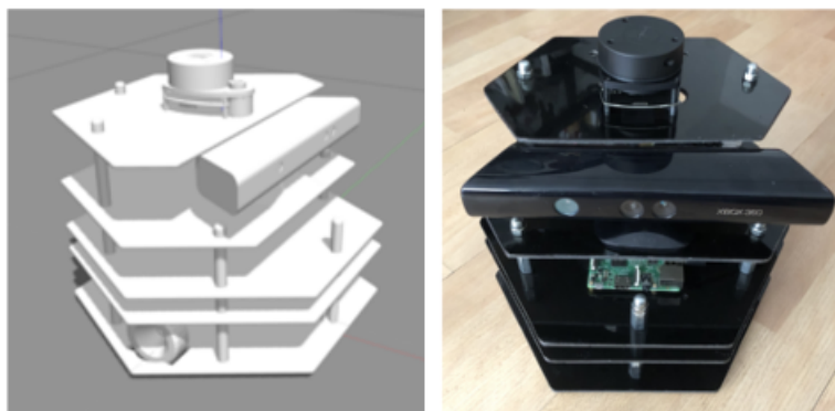
FIGURE 1.9 : Version du robot mobile utilisée lors des premières simulations dans le cadre de cette thèse, à gauche une version logicielle du robot pour les simulations à l'aide du logiciel Gazebo et à droite le robot que nous avons conçu pour les expérimentations en environnement réel.
