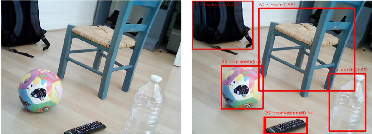
FIGURE 3.26 : Détection des objets : L'image RGB de gauche montre l'image tel qu'elle est reçu par le capteur RealSens RS300. L'image de droite montre la reconnaissance des objets encadrés en rouge avec le label correspondant et l'indice de confiance.
