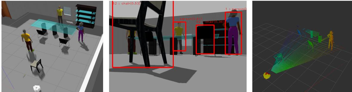
FIGURE 3.27 : L'image de gauche montre l'environnement virtuel **Gazebo** dans lequel le robot évolue. L'image du milieu montre la reconnaissance des obstacles à travers le capteur RGB. La dernière image à droite montre le rendu du capteur de profondeur dans **Rviz**.
