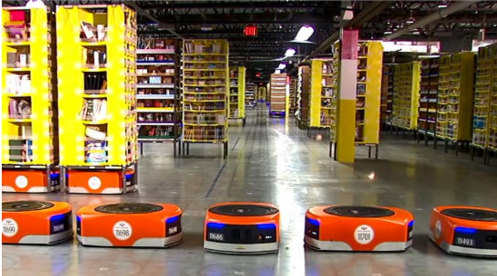
FIGURE 1.4 : Premier centre de distribution robotisé de la société **Amazon** à Brétigny-sur-Orge en France (2014), les robots ont permis de réduire le temps d'acheminement des colis à 13 minutes contre une heure et demie en moyenne auparavant.
